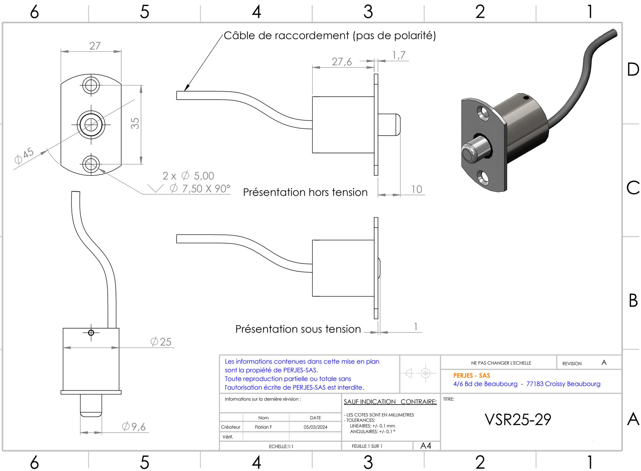
Câble de raccordement (pas de polarité)
