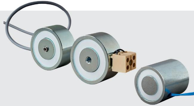
Le maintien de la pièce est obtenu lorsque celle - ci est au contact de la ventouse et que l'on alimente électriquement la ventouse.
